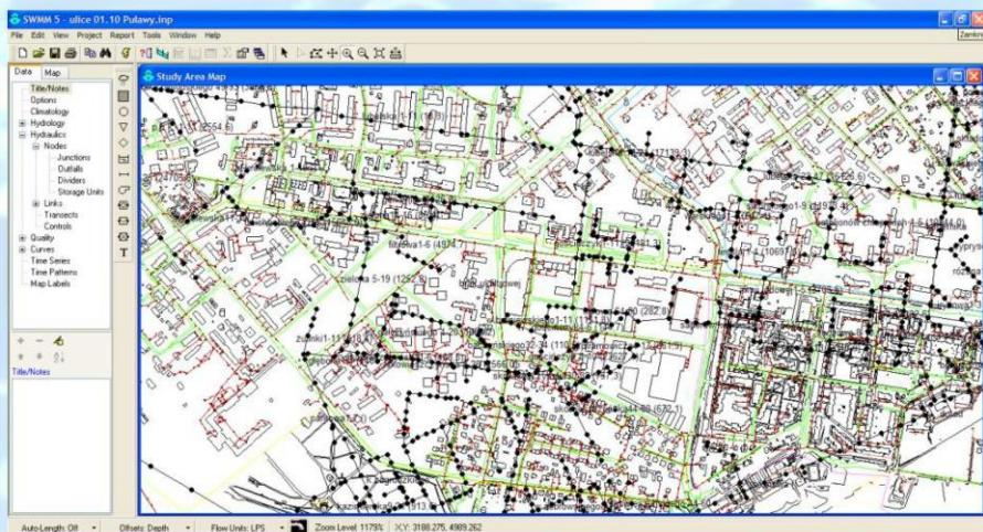
Rys. 4. Model sieci kanalizacyjnej w programie SWMM z wykorzystaniem Modelu Menagera do współpracy modelu z bazą GIS
